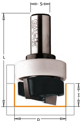
Фрезы для врезания петель CMT PRO снабжены толстыми врезными твердосплавными напайками. Особенности конструкции фрез - отрицательный наклон режущей части для выборки идеальных пазов с ровными краями и дном. Фрезы отлично работают как с твердой и мягкой древесиной, так и с другими материалами на основе дерева. Подходят к большинству кондукторов для изготовления дверных петель.
